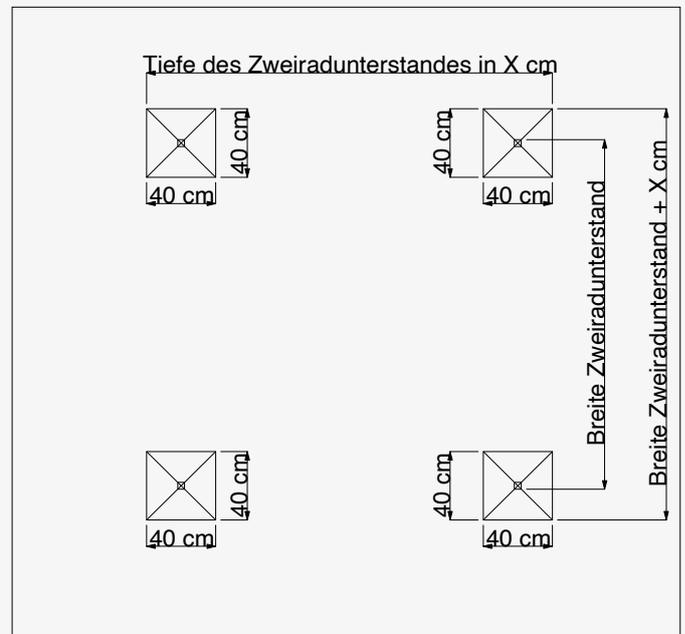
BEISPIEL FÜR DEN FUNDAMENTPLAN EINES CERVOTEC ZWEIRADUNTERSTANDS
